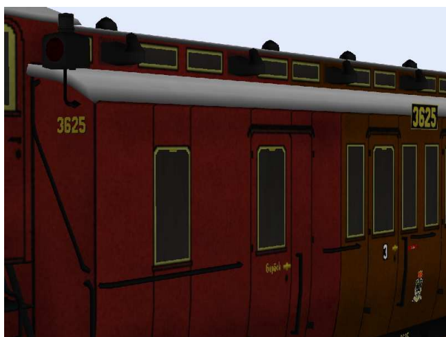
Wagen mit Lüftern der Einheitsbauart Berlin 3625
