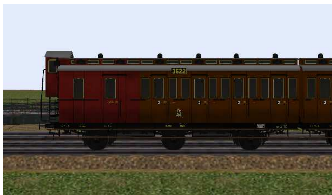
kurzgekuppelter Wagen 3.Klasse mit kombiniertem Gepäckabteil, Nummern Berlin 2522/3622, mit/ohne Bremserhaus.
