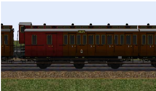
kurzgekuppelter Wagen 3.Klasse mit kombiniertem Gepäckabteil, Nummern Berlin 2525/3625, mit/ohne Bremserhaus.
