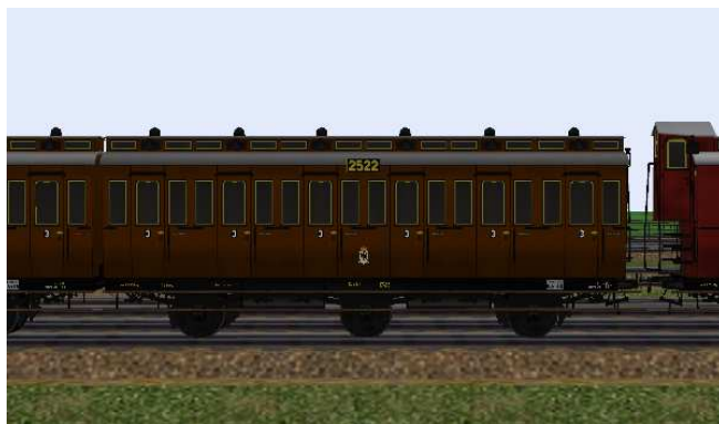
kurzgekuppelter Wagen 3.Klasse mit kombiniertem Gepäckabteil, Nummern Berlin 2522/3622, mit/ohne Bremserhaus.
