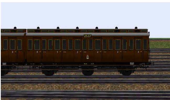
kurzgekuppelter Wagen 3.Klasse mit kombiniertem Gepäckabteil, Nummern Berlin 2537/3656, mit/ohne Bremserhaus.
