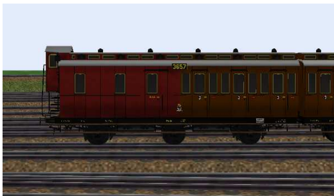
kurzgekuppelter Wagen 3.Klasse mit kombiniertem Gepäckabteil, Nummern Berlin 2538/3657, mit/ohne Bremserhaus.
