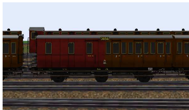
kurzgekuppelter Wagen 3.Klasse mit kombiniertem Gepäckabteil, Nummern Berlin 2537/3656, mit/ohne Bremserhaus.
