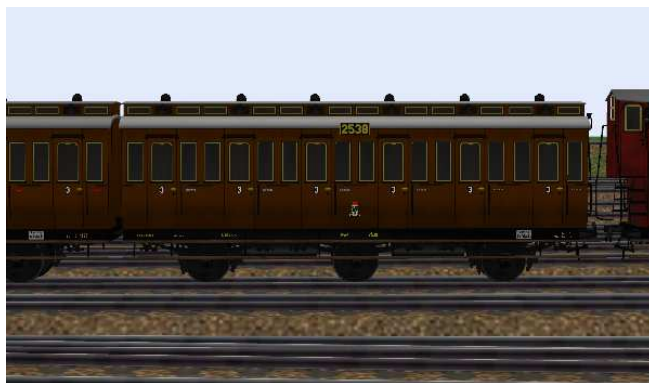
kurzgekuppelter Wagen 3.Klasse mit kombiniertem Gepäckabteil, Nummern Berlin 2538/3657, mit/ohne Bremserhaus.
