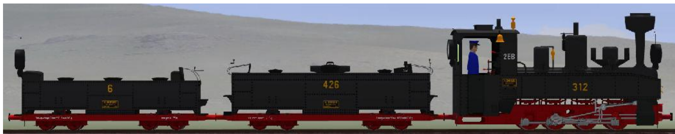
Borsig 8836 Bj 1914 – HF 312 – Lok Nr. 8 des Frankfurter Feldbahnmuseums (ex. BR 99 3313) Tender 426 neue Bauform (heute ebenfalls in Frankfurt im Einsatz) und Tender 6 alte Bauform. (Modellname: Brigadelok312, Tender6, Tender426 – enthalten in: V70NKK10016)
