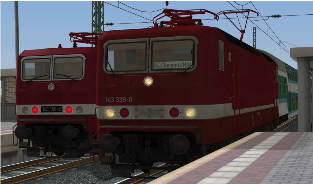
Beleuchtung: 2-Licht-Zugschluß- (links) und 3-Licht-Spitzensignal (rechts)
