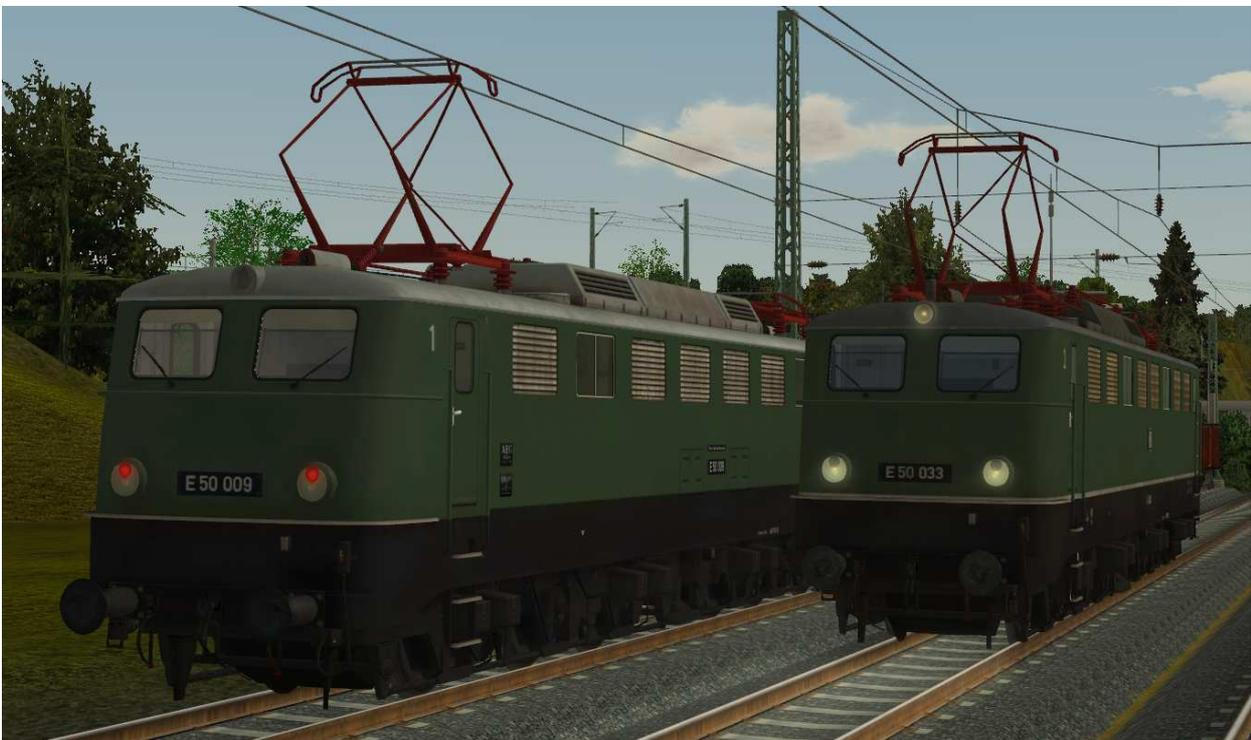
Beleuchtung: 2-Licht-Zugschluß- (links) und 3-Licht-Spitzensignal (rechts)
