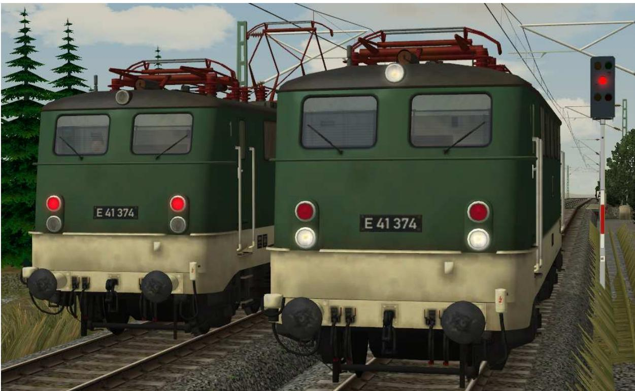
Beleuchtung: 2-Licht-Zugschluß- (links) und 3-Licht-Spitzensignal (rechts)
