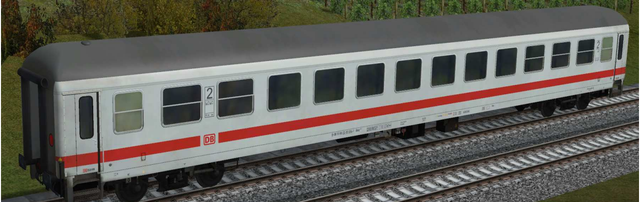
IR-Wagen 2.Klasse – mit geschlossenem WC-System und Einspannungseinrichtung
