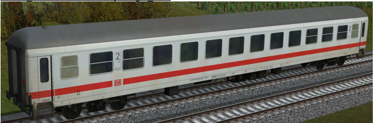
R-Wagen 2.Klasse – mit geschlossenem WC-System und Mehrspannungseinrichtung
