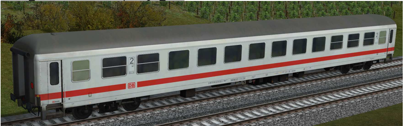
IR-Wagen 2.Klasse – mit offenem WC-System und Mehrspannungseinrichtung
