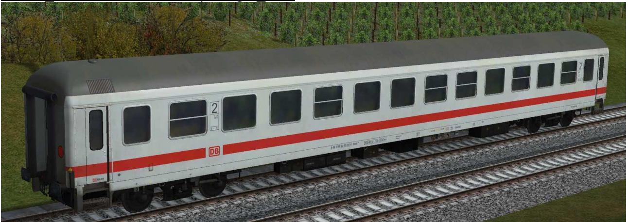
IR-Wagen 2.Klasse mit Fahrradabteil – mit geschlossenem WC-System und Mehrspannungseinrichtung
