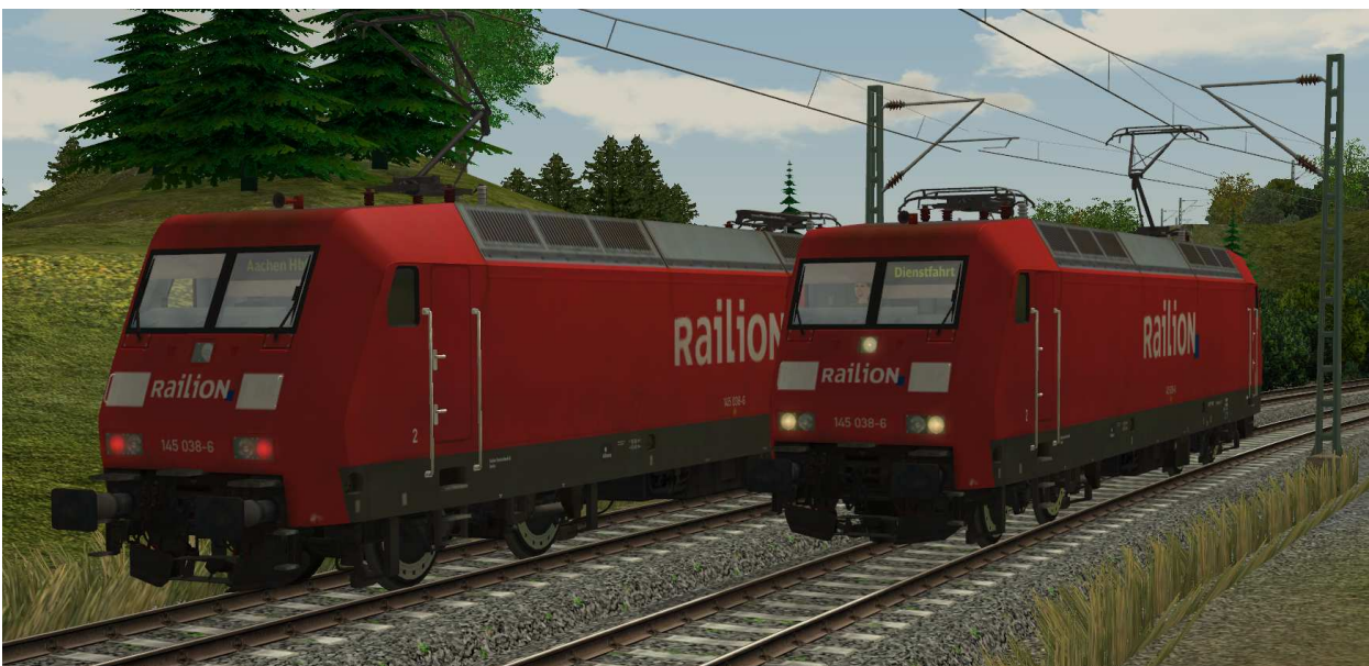
Beleuchtung: 2-Licht-Zugschluß- (links) und 3-Licht-Spitzensignal (rechts)
