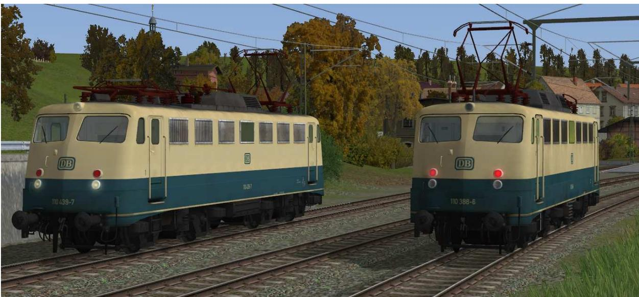
Beleuchtung: 2-Licht-Zugschluß- (rechts) und 3-Licht-Spitzensignal (links)
