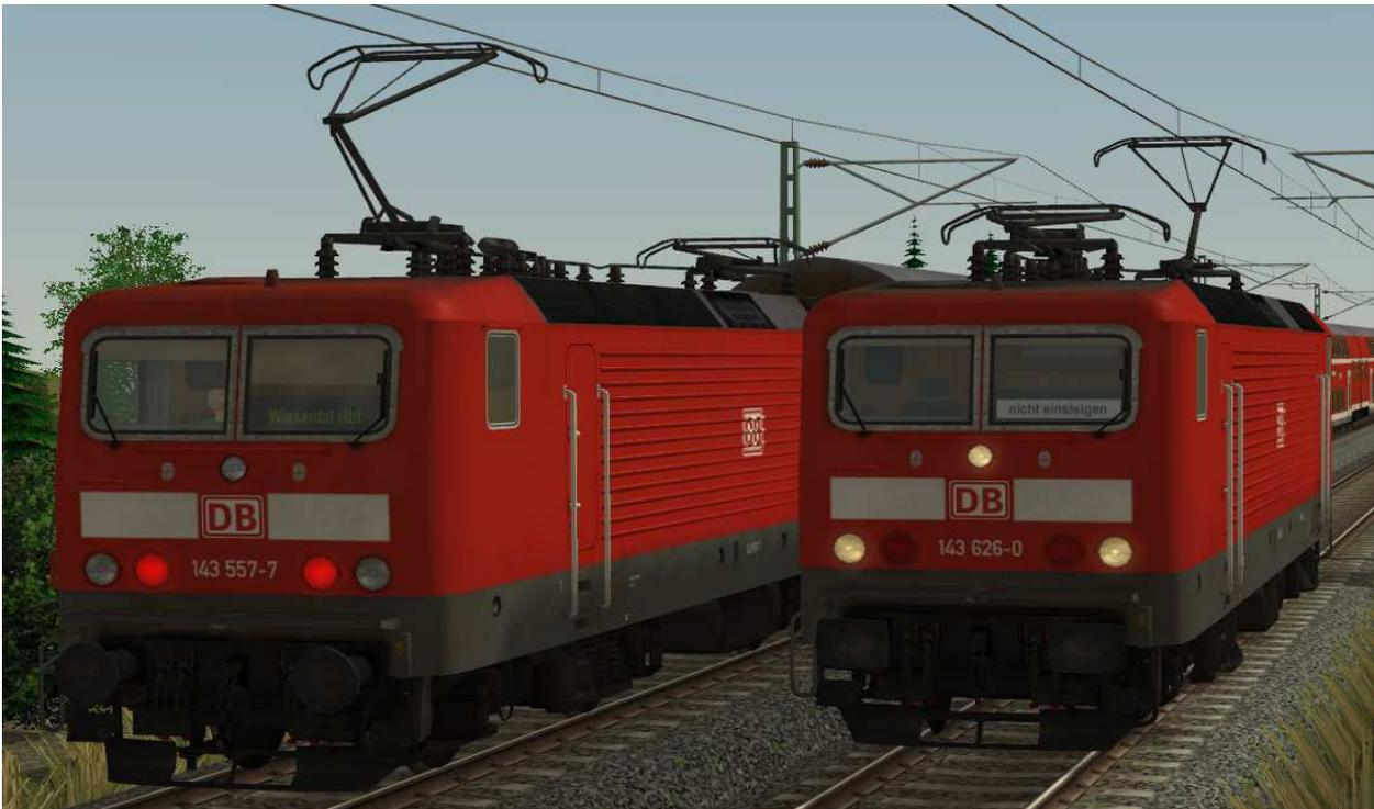
Beleuchtung: 2-Licht-Zugschluß- (links) und 3-Licht-Spitzensignal (rechts)
