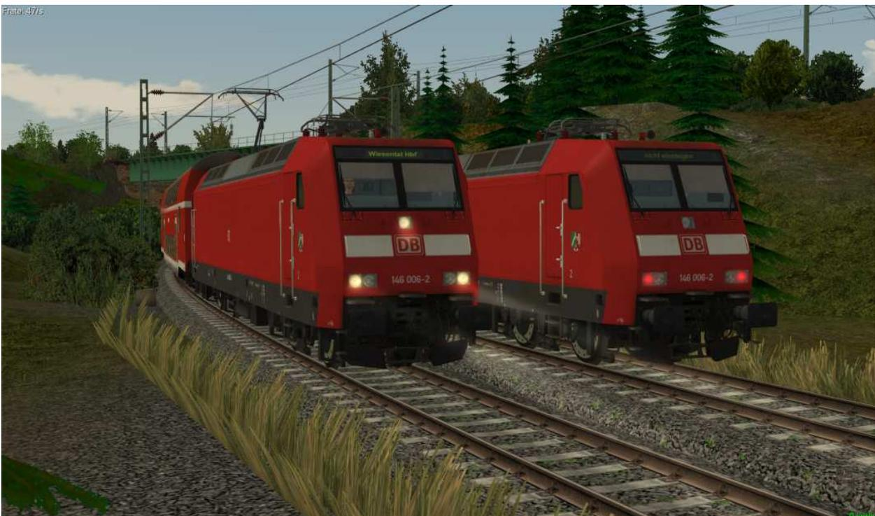
Beleuchtung: 2-Licht-Zugschluß- (rechts) und 3-Licht-Spitzensignal (links)
