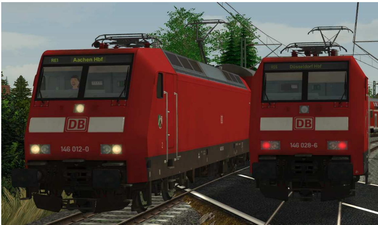
Beleuchtung: 2-Licht-Zugschluß- (rechts) und 3-Licht-Spitzensignal (links)
