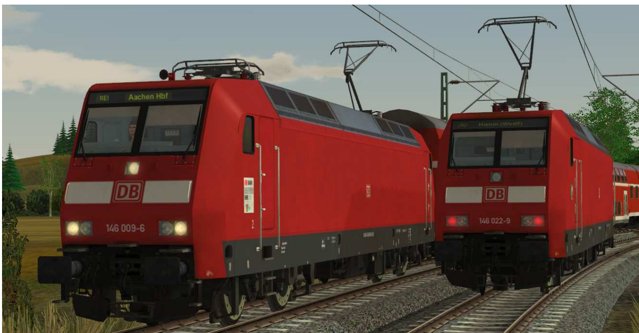
Beleuchtung: 2-Licht-Zugschluß- (rechts) und 3-Licht-Spitzensignal (links)
