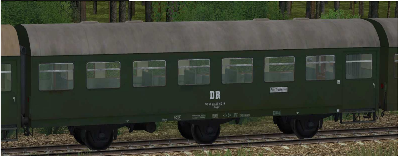
dreiachsiger Umbauwagen 2.Klasse mit Traglastenabteil – ohne el. Heizung
