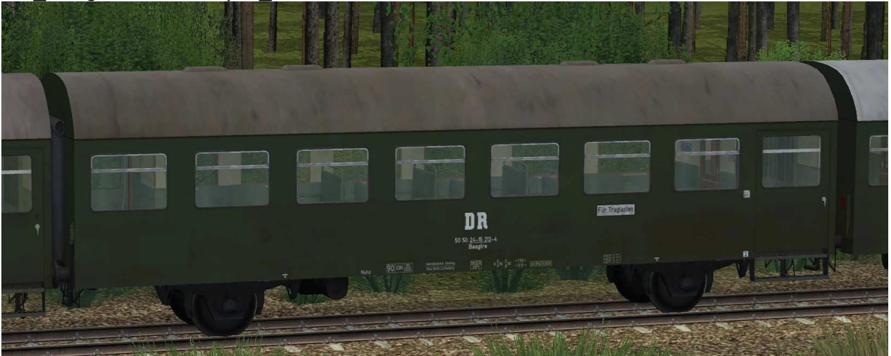
zweiachsiger Umbauwagen 2.Klasse mit Traglastenabteil
