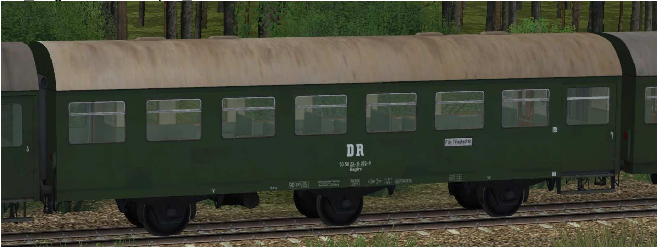
dreiachsiger Umbauwagen 2.Klasse mit Traglastenabteil
