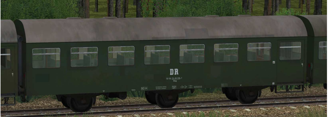
dreiachsiger Umbauwagen 2.Klasse, ohne el. Heizung
