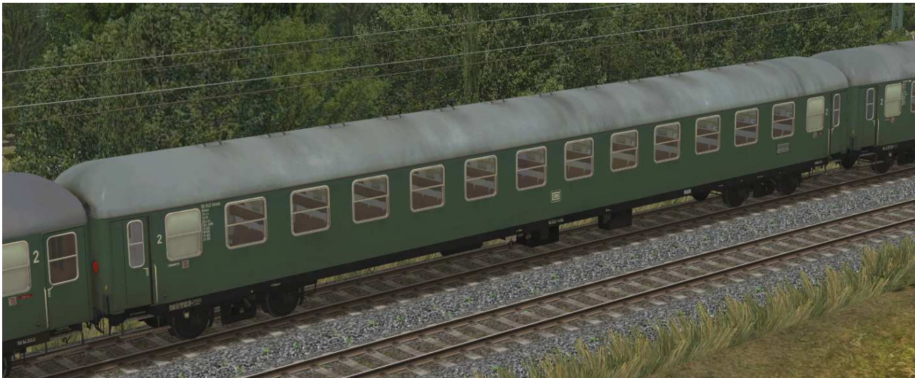
zweite Klasse Reisezugwagen der Gattung B4üm61, erstes Baujahr 1961 mit Drehfalttüren und kleinen Abteilfenstern
