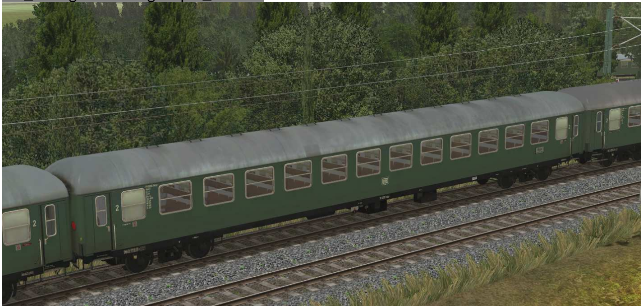
zweite Klasse Reisezugwagen der Gattung B4üm63, erstes Baujahr 1963 mit Drehfalttüren und großen Abteilfenstern
