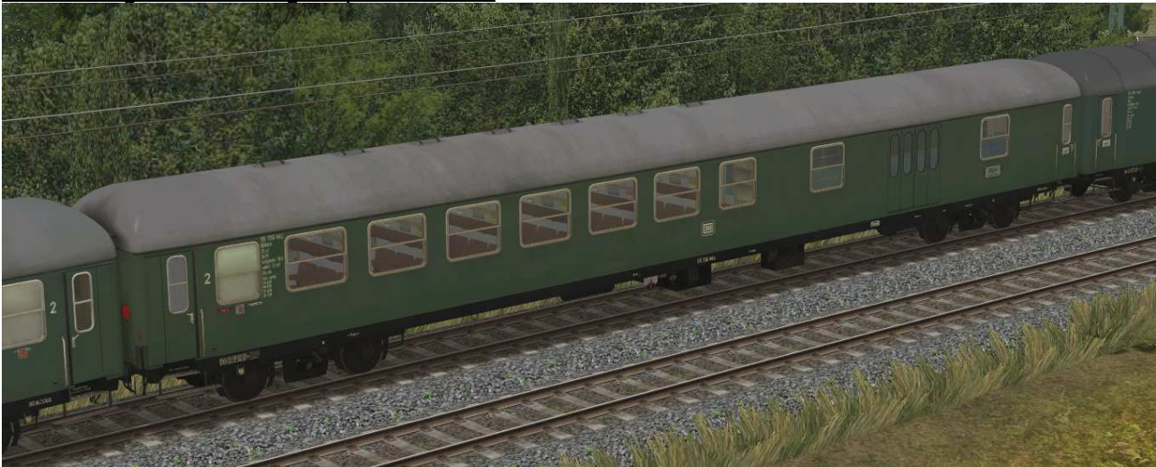
Sitzwagen zweite Klasse mit Gepäckabteil Gattung BD4um61, erstes Baujahr 1959, mit Drehfalttüren und großen Abteilfenstern im Sitzbereich
