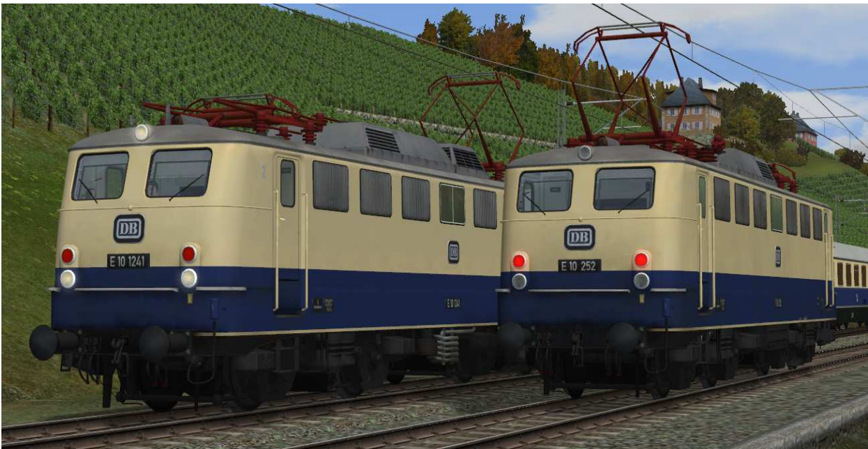
Beleuchtung: 2-Licht-Zugschluß- (rechts) und 3-Licht-Spitzensignal (links)
