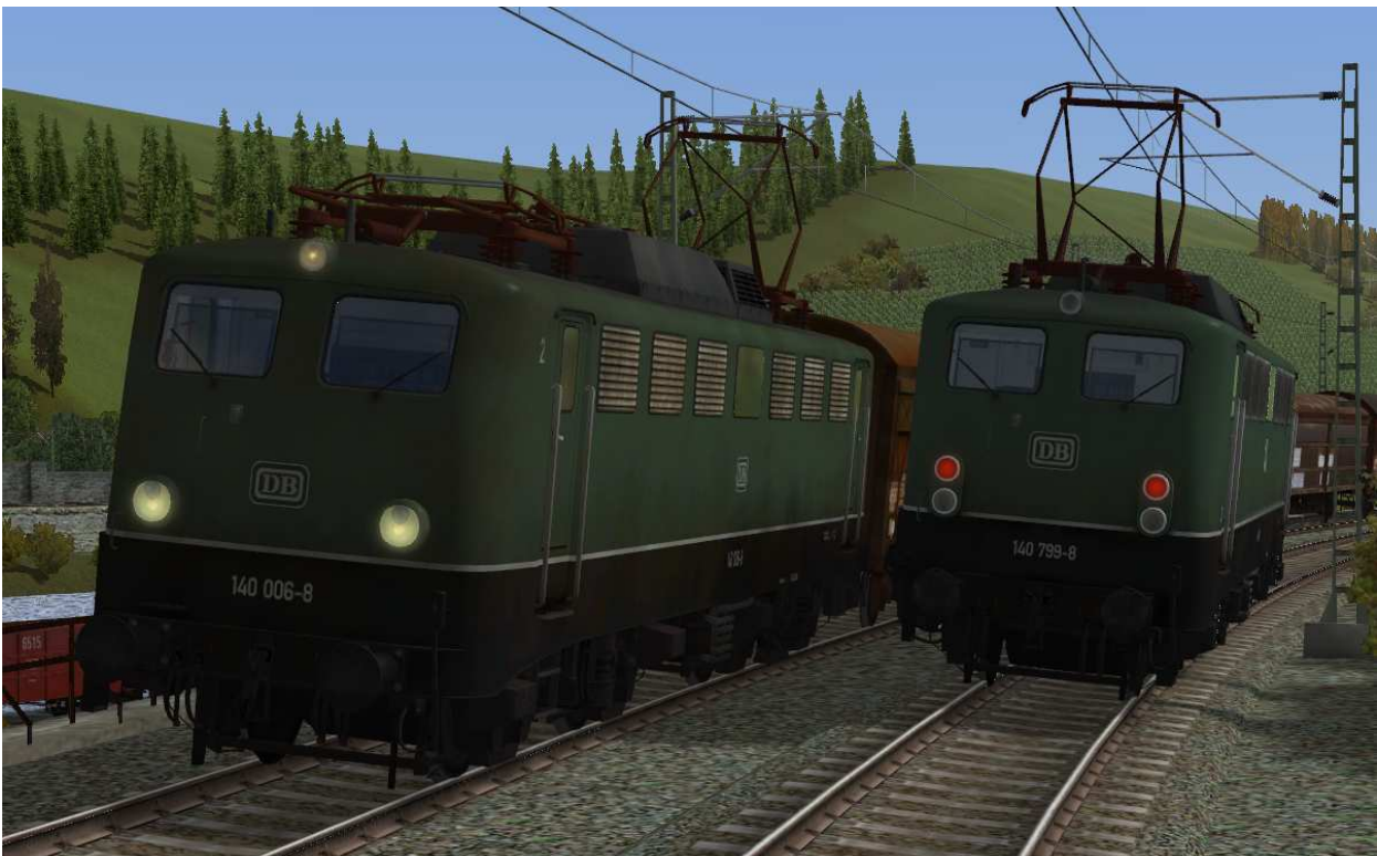
Beleuchtung: 2-Licht-Zugschluß- (rechts) und 3-Licht-Spitzensignal (links)
