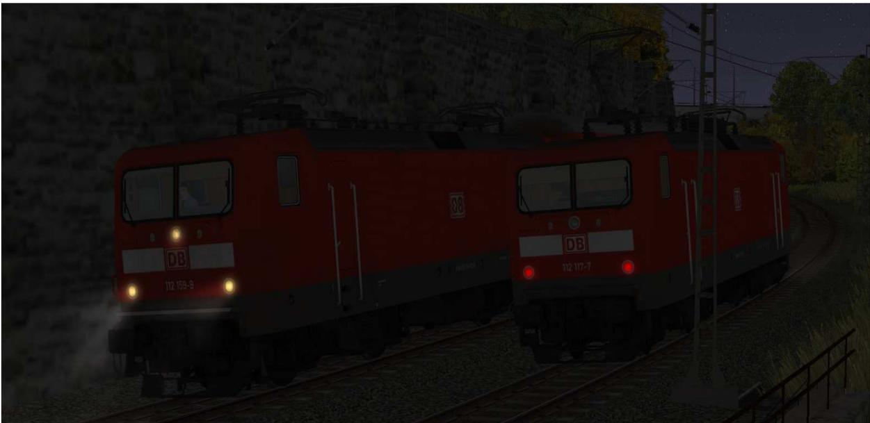
Beleuchtung: 2-Licht-Zugschluß- (rechts) und 3-Licht-Spitzensignal (links)
