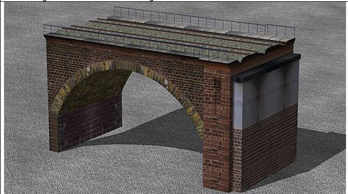
Gleisobjekt Biehl_2_Endbogen_G_AF1: 2gl Gewölbe mit gelbem Gewölbebogen zum Übergang zwischen Stein auf Stahl, Gleislänge 22 m, links und (um 180 ° gedreht) rechts verwendbar. Lichte mittige Durchfahrtshöhe 10 m. Eingerichtet für Gleisstile mit Schotterbett.
