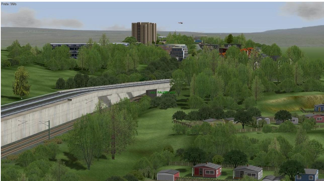
**Abb.11** Bei der Verdopplung der Sichtweite auf 3,0 km bei gleicher Perspektive, können lediglich 36 FPS errechnet werden.
