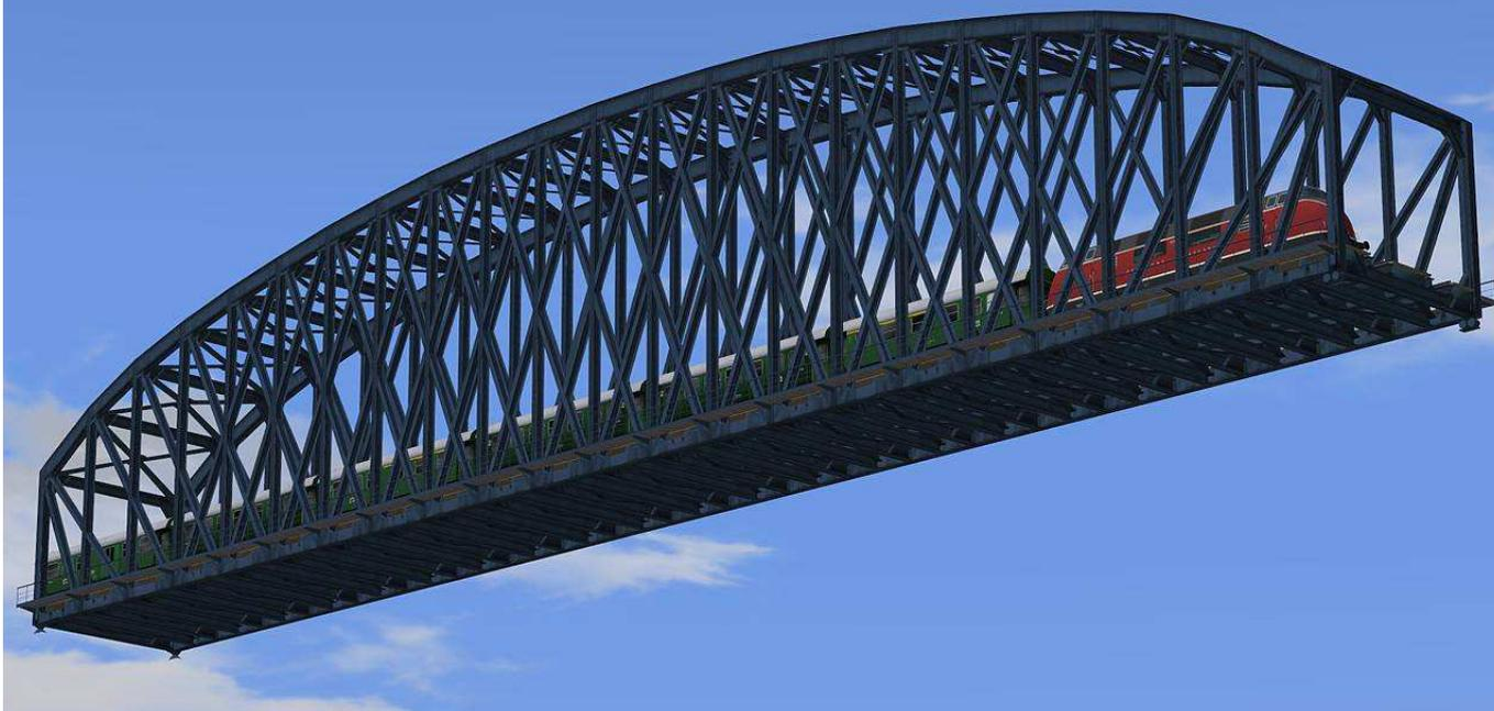
**Gleisobjekt Biehl\_2\_Fachwerk98\_AF1:** blaue Stahl-Fachwerkbogenbrücke; 98 m lang; zwei-gleisig. Mit Holzbeplankung und sichtbarer Unterkonstruktion. Beidseitige Laufstege mit Geländern. Voll detailliertes Modell mit ausgestalteter Unterseite. Gleislänge 98,02 m zum Schaffen von Dehnungsfugen.
