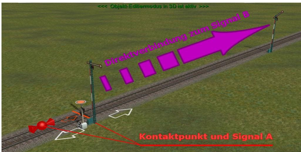
**Abb.4** Direkte Schaltverbindung zwischen Signalen bei einer Blockstreckensicherung
