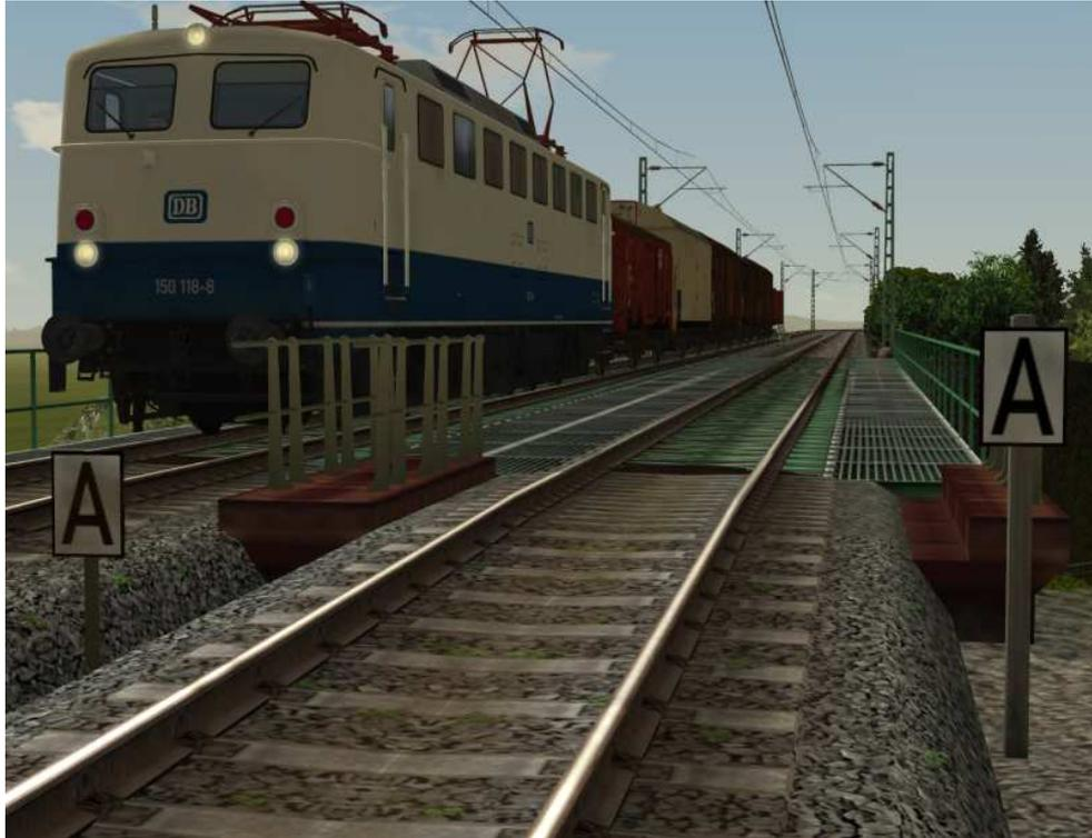
Signale Lf5 markieren die Stelle, an der die Geschwindigkeitsbeschränkung ausgeführt sein muss.
