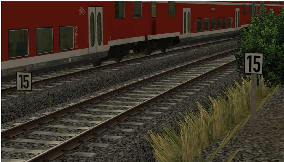
Signale Lf7 markieren die Stelle, an der die Geschwindigkeitsbeschränkung ausgeführt sein muss. Auch hier entspricht der 10-fache Wert der angeschriebenen Zahl der einzuhaltenden Höchstgeschwindigkeit.
