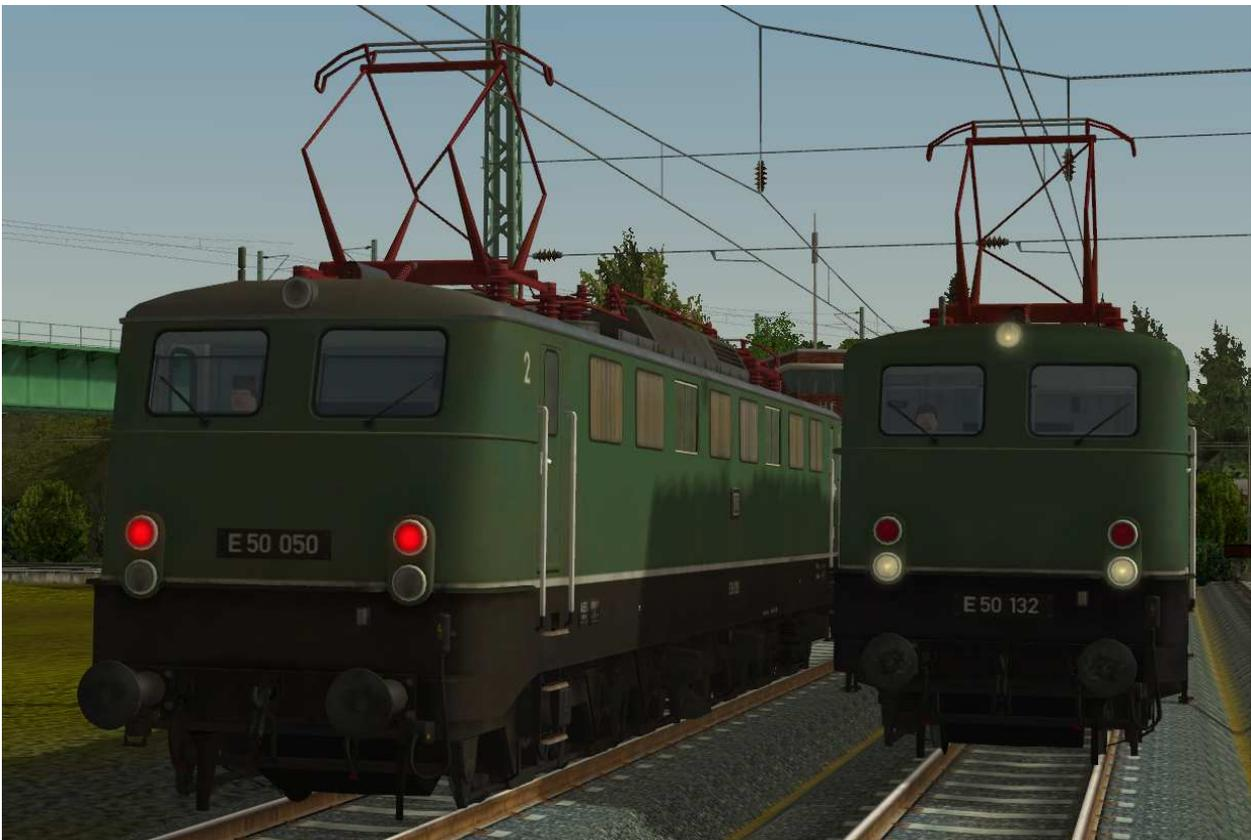
Beleuchtung: 2-Licht-Zugschluß- (links) und 3-Licht-Spitzensignal (rechts)
