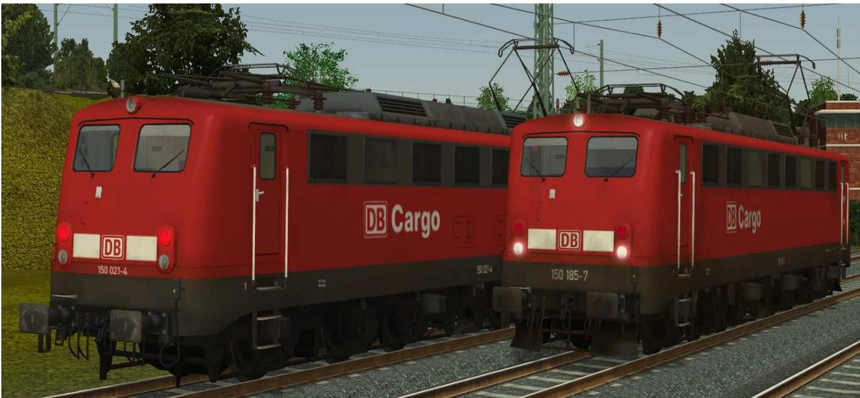
Beleuchtung: 2-Licht-Zugschluß- (links) und 3-Licht-Spitzensignal (rechts)
