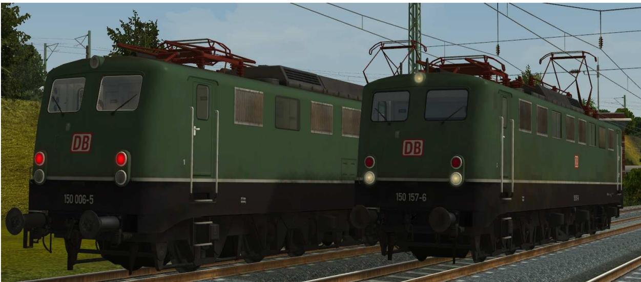
Beleuchtung: 2-Licht-Zugschluß- (links) und 3-Licht-Spitzensignal (rechts)
