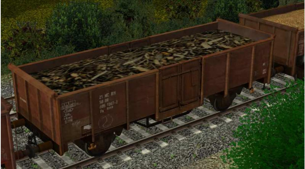
offener zweiachsiger Güterwagen der Sonderbauart für den Schrottverkehr mit Stahlboden, umgebaut im RAW Dresden ab 1980
