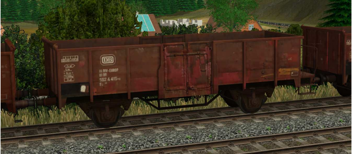
Neubauwagen der DB mit breiter Bremserbühne, Baujahr ab 1955
