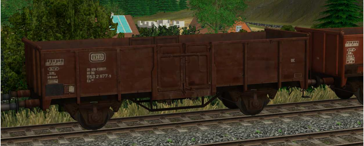
Umbauwagen der DB, Umbau ab 1981 aus E(s) 039
