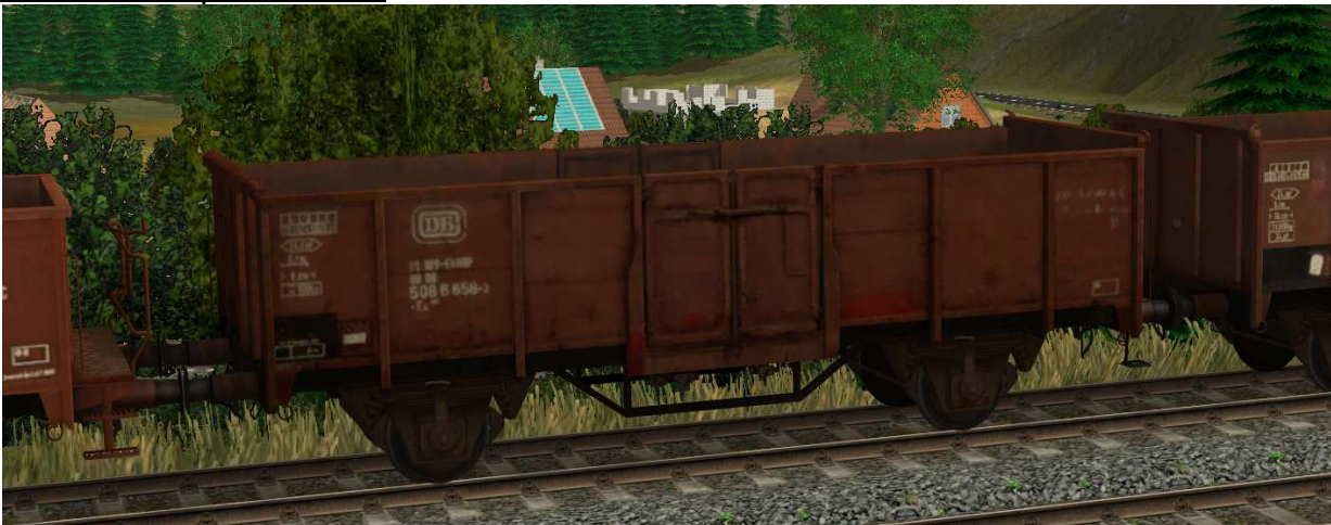
Umbauwagen der DB, Umbau ab 1984 aus E(s) 035
