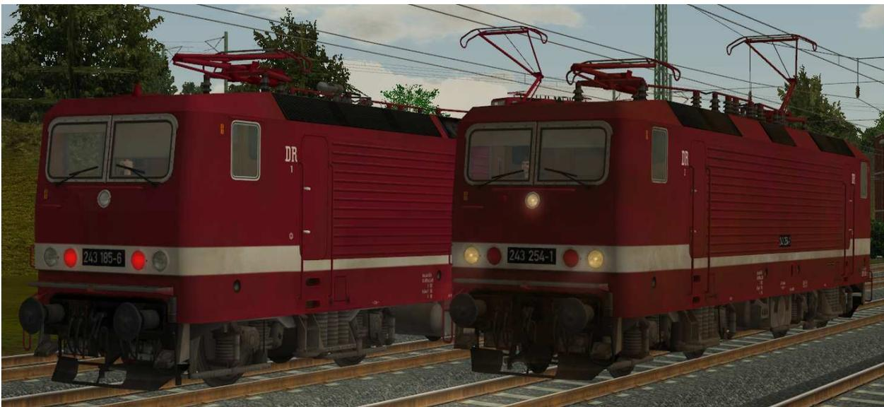
Beleuchtung: 2-Licht-Zugschluß- (links) und 3-Licht-Spitzensignal (rechts)
