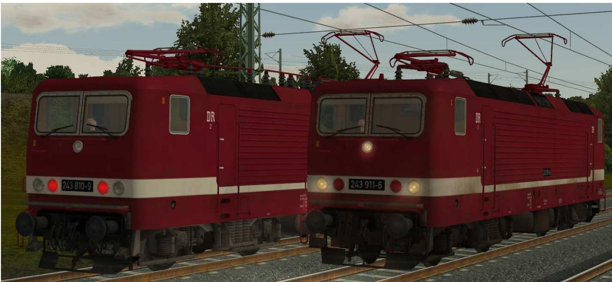
Beleuchtung: 2-Licht-Zugschluß- (links) und 3-Licht-Spitzensignal (rechts)
