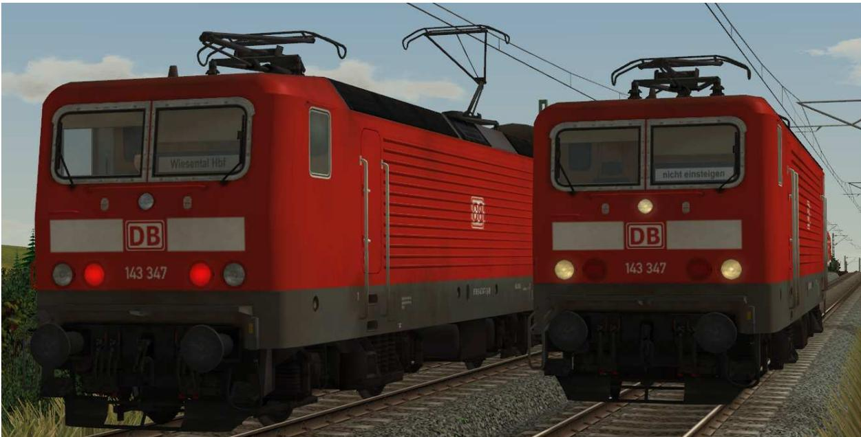
Beleuchtung: 2-Licht-Zugschluß- (links) und 3-Licht-Spitzensignal (rechts)
