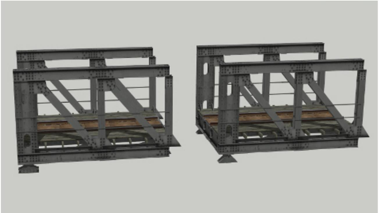
Gleisobjekt **R-Geraet\_1\_A\_bA**, linkes Portal aus zwei Halb-K-Elementen — Gleislänge 6,71 m — mit verstärkter Portalstütze und beweglichem Auflager; rechts daneben **R-Geraet\_1\_A\_fA**, das linke Portal mit festem Auflager.
