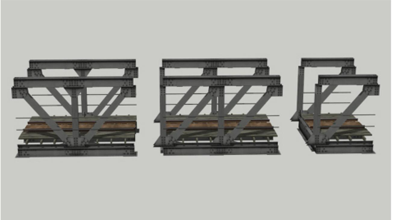
Links: Gleisobjekt **R-Geraet\_1\_C**, Mittelteil aus zwei gespiegelten Halb-K-Elementen, Gleislänge 6,00 m
