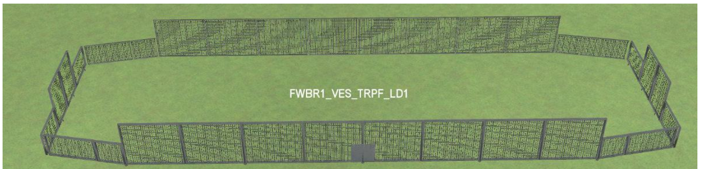
Einzelteile Teil 5: Vogeleinflugschutz am Trennpfeiler
