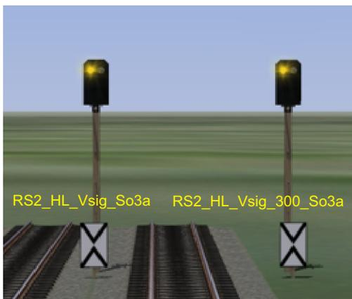
Die Signale 'RS2\_HL\_Vsig\_So3a' und 'RS2\_HL\_Vsig\_300\_So3a' sind als normale Vorsignale konstruiert. 'RS2\_HL\_Vsig\_So3a' hat einen Gleismittenabstand von 2,25 Metern, 'RS2\_HL\_Vsig\_300\_So3a' einen Gleismittenabstand von 3,00 Metern. Die Signale haben 4 Signalbilder. Die Signale haben keine Zugbeeinflussung.
