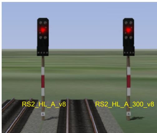
Die Signale 'RS2\_HL\_A\_v8' und 'RS2\_HL\_A\_300\_v8' sind als Ausfahrt- und Zwischensignale konstruiert. 'RS2\_HL\_A\_v8' hat einen Gleismittenabstand von 2,25 Metern, 'RS2\_HL\_A\_300\_v8' einen Gleismittenabstand von 3,00 Metern. Die Signale haben 19 Signalbilder.
