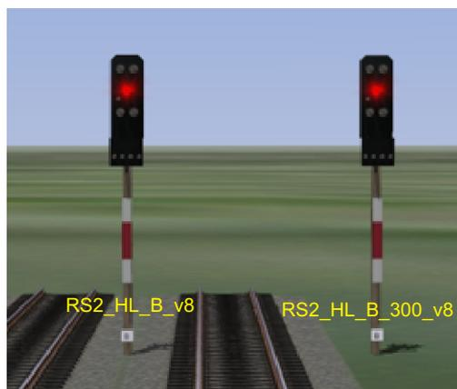
Die Signale 'RS2\_HL\_B\_v8' und 'RS2\_HL\_B\_300\_v8' sind als Einfahrt- und Streckensignale konstruiert. 'RS2\_HL\_B\_v8' hat einen Gleismittenabstand von 2,25 Metern, 'RS2\_HL\_B\_300\_v8' einen Gleismittenabstand von 3,00 Metern. Die Signale haben 18 Signalbilder.
