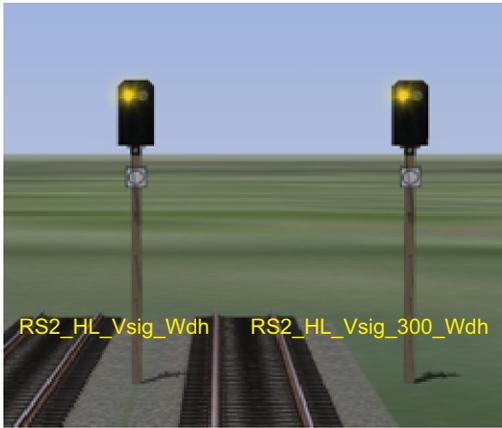
Die Signale 'RS2\_HL\_Vsig\_Wdh' und 'RS2\_HL\_Vsig\_300\_Wdh' sind als Vorsignalwiederholer konstruiert. 'RS2\_HL\_Vsig\_Wdh' hat einen Gleismittenabstand von 2,25 Metern, 'RS2\_HL\_Vsig\_300\_Wdh' einen Gleismittenabstand von 3,00 Metern. Die Signale haben 4 Signalbilder. Die Signale haben keine Zugbeeinflussung.
