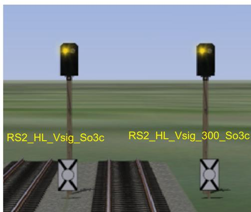
Die Signale 'RS2\_HL\_Vsig\_So3c' und 'RS2\_HL\_Vsig\_300\_So3c' sind als Vorsignale mit verkürztem Bremsweg konstruiert. 'RS2\_HL\_Vsig\_So3c' hat einen Gleismittenabstand von 2,25 Metern, 'RS2\_HL\_Vsig\_300\_So3c' einen Gleismittenabstand von 3,00 Metern. Die Signale haben 4 Signalbilder. Die Signale haben keine Zugbeeinflussung.
