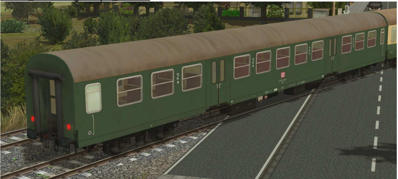
Großraumreisezugwagen der Gattung Bmh2111 in grüner Farbgebung und grauen Dach, Ausführung EpIV, Vmax 120 km/h
