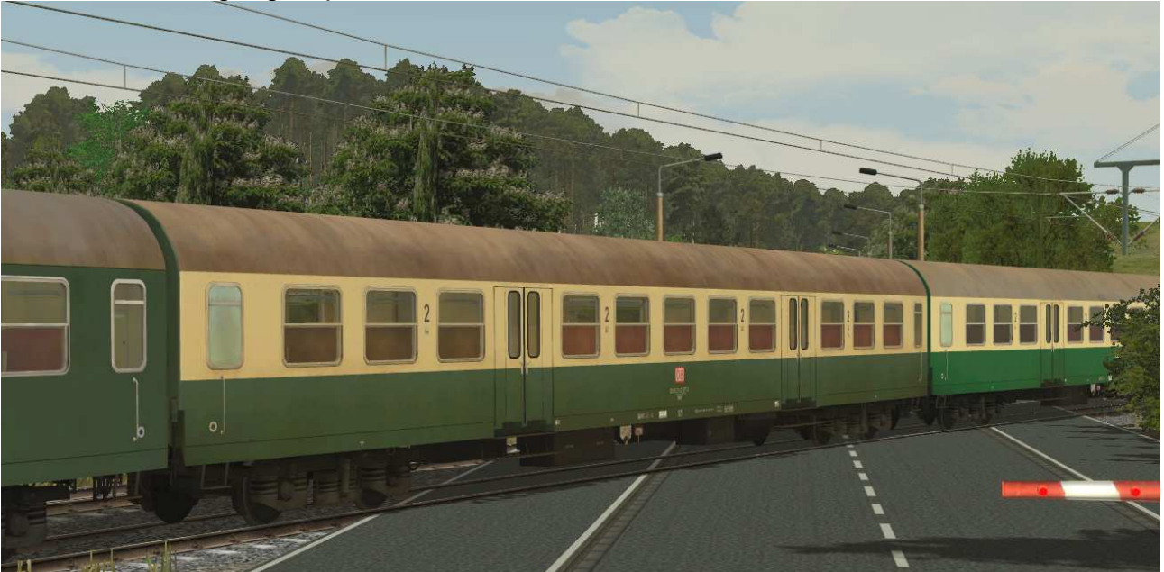
Großraumreisezugwagen der Gattung Bmh2140 in grün/beiger Farbgebung und braunem Dach, Ausführung EpIV, Vmax 140 km/h
