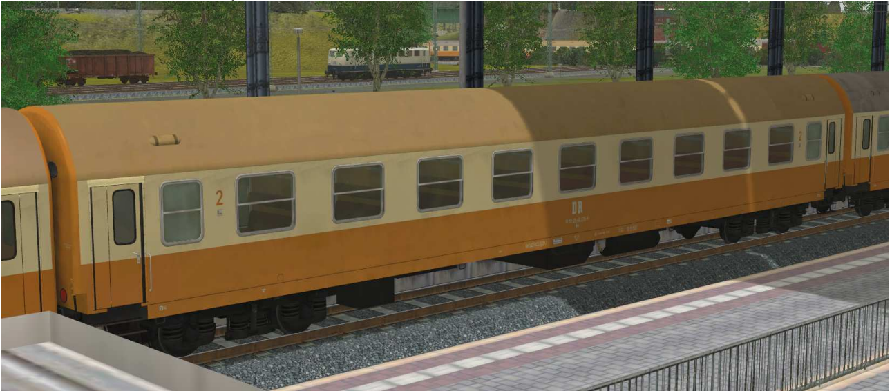
Abteilwagen 1.Klasse Typ YB70 der DR, Einsatz ab 1976, später Rückbau in erste Klasse-Wagen
