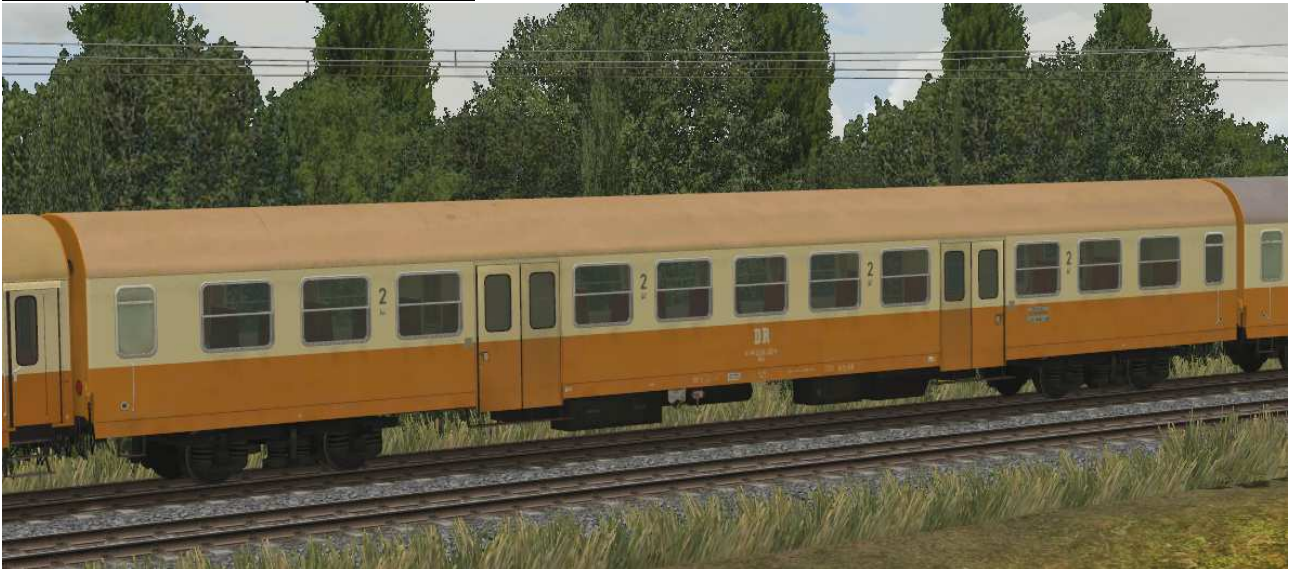
Großraumreisezugwagen 2.Klasse mit Schwenkschiebetüren Bauart Bautzen, Einzelexemplar
