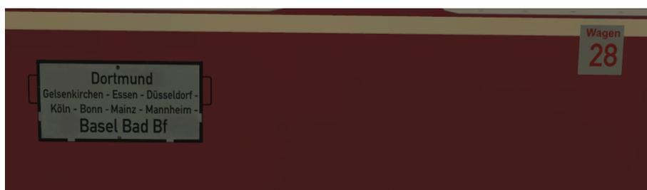
Die Zuglaufschilder können an den Außenseiten mittels Schieberegler abgehängt werden.
