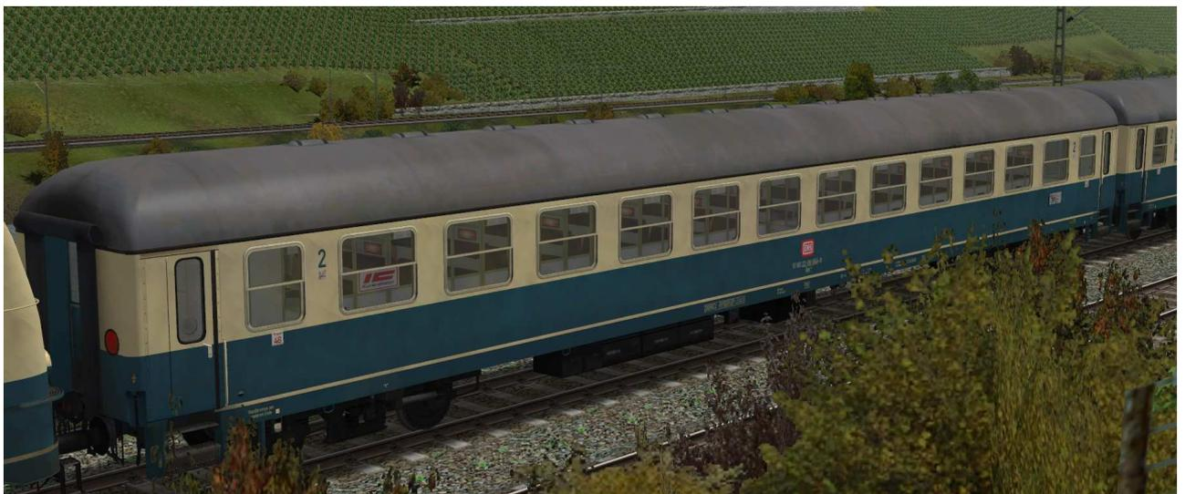
Sitzwagen 2.Klasse Gattung Bm235 in EpIVb mit Drehfältüren, Klapptrittstufen und großen Abteilfenstern, Raucher-/Nichtraucher-Piktogrammen für Einsatz in IC-Zügen, zul. Geschwindigkeit 200 km/h mit IC Kurier-Abteil (Umbau aus Bm234)
