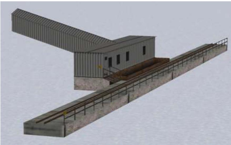
Gleisrampe für die 600mm Spur mit Trichter, Motorenhaus und Förderbrücke zum Anschluss an die Beladestation der Seilbahn oder an passende Silos.
